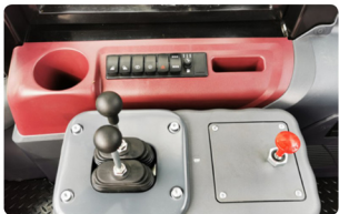
先导操纵，操作灵活、精准，效率更高。
