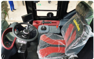
可调转向柱配合多向调整座椅，最佳坐姿全面提升驾控舒适性。
